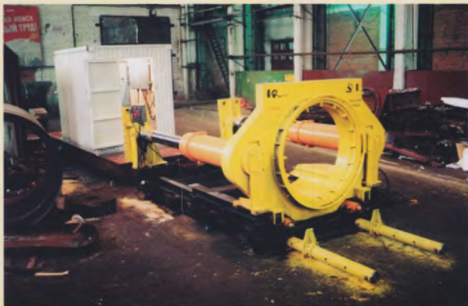
Рис. 2. Установка для продавливания труб УДП-1,5
