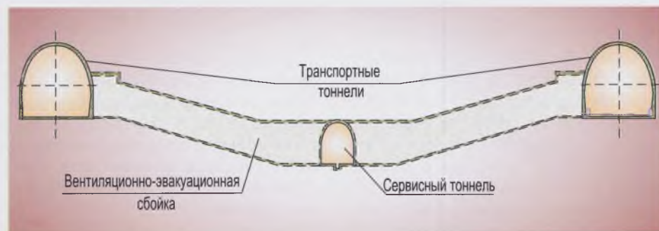
Рис. 4. Расположение транспортных и сервисного тоннелей
