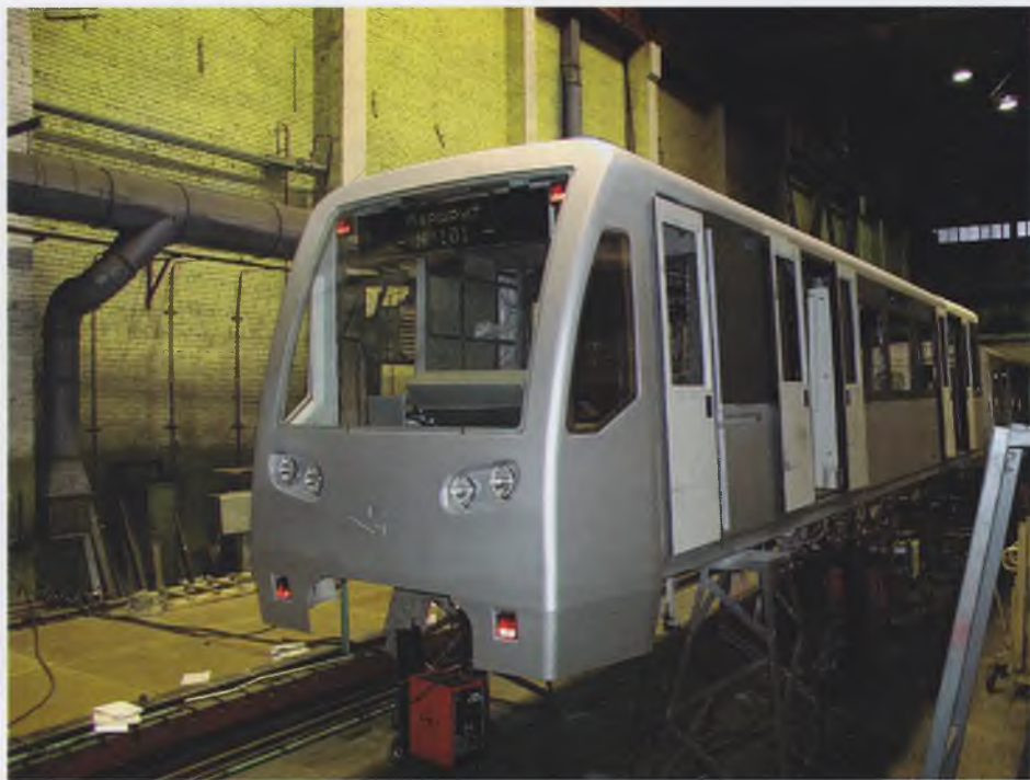
Монтаж новой серии вагонов на сборочной линии завода
